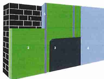
1. Buitengevel | 2. Isolatie | 3. Dampschermbekleding | 4. Binnenafwerking | 5. Stijl- en regelwerk (optioneel)
